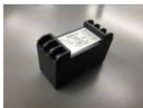
直流電圧測定装置 DCPT
