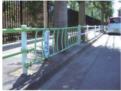
緊急時に担架として使えるガードパイプ
