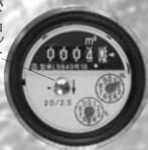
水道メーター
