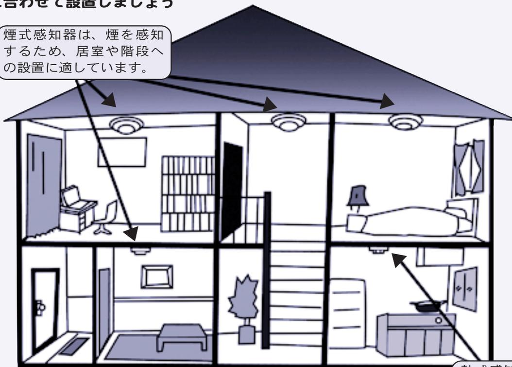
熱式感知器は、熱を感知するため、台所への設置に適しています。
