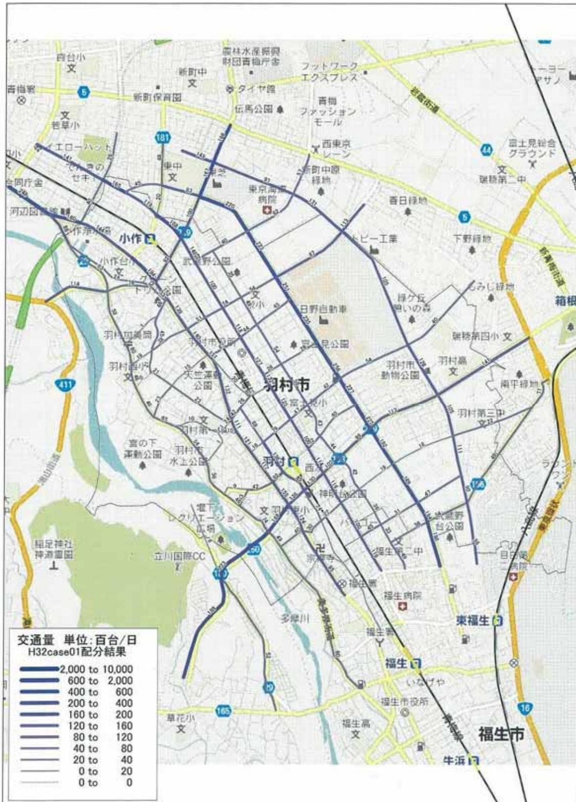
図 3-3 : 整備有り (CASE1) の交通量推計結果
