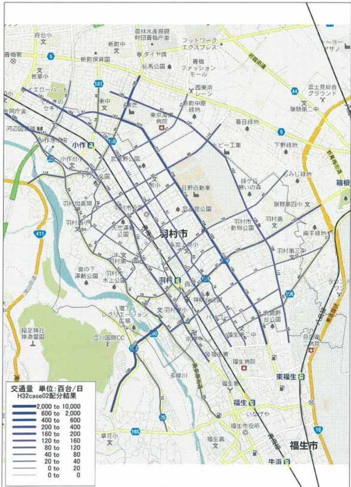
図 3-4 : 整備無し (CASE2) の交通量推計結果
