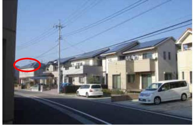
写真：屋根形状によって、ソーラーパネルの敷設枚数に制約
