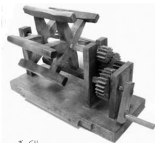
▲座繰…まゆを煮る鍋から数本の糸を取り出し、撚りをかけながら糸枠に巻いていく道具
