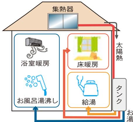
**クール先生** 作ったお湯をためるタンクが屋根についている自然循環式と、地上に設置されている強制循環式のタイプがあるよ。強制循環式の場合は屋根には集熱器だけを取り付けるんだ。
