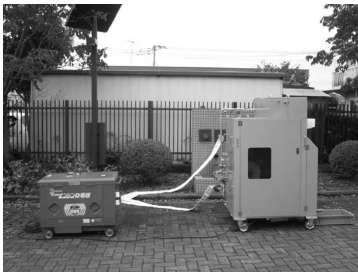
【応急給水装置 (ウォーターパッカー)】
