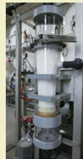
水をろ過するための装置。この中を通って水がろ過される。上写真の膜ろ過ユニットの中にこれが5,040本も入っている
