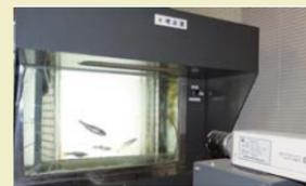
▲浄水場で水質の安全を確認するために、水槽で魚を飼っている
