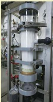
◀水をろ過するための装置。この中を通して水がろ過される。上写真の膜ろ過ユニットの中にこれが5,040本も入っている
