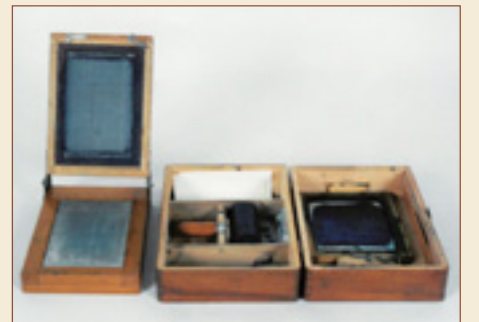
▲左が印刷に使う謄写機、右がインクやローラーなどの一式
