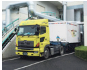
▲スイミングセンターのボイラーとつながれた蓄熱槽
