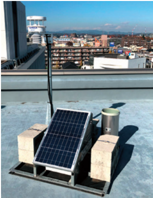
市役所屋上に設置した 気象観測装置「ポテカ」
