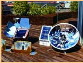
▲電気やガスを使わず太陽熱だけで調理できるソーラークッカー
