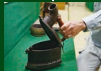
▲(上)「火のし」は持ち手の先についている金属の器に熱した炭を入れ、その熱と重みで布のシワをのばします。このような仕組みの道具は約1,000年前の平安時代のころから使われていました。(下) 現代のアイロンの形状に近づいてきましたね。蓋を開けて中に炭を入れて使っていたようです。
