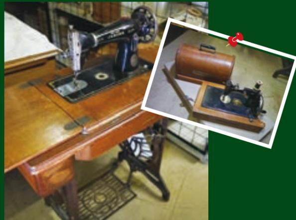
▲足踏み式のミシン(左)。昭和39年頃のもので、ミシンは台の中に収納できる仕組みになっています。ミシンの左側は作業スペースとして使え、とても便利。見た目もオシャレです。右のミシンは持ち運びできるタイプ。こちらは昭和12年頃に使われていたようです。
