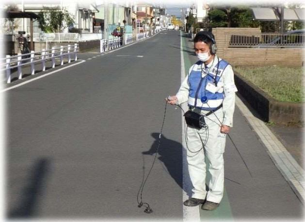
＜漏水探知機による路面音聴調査＞
