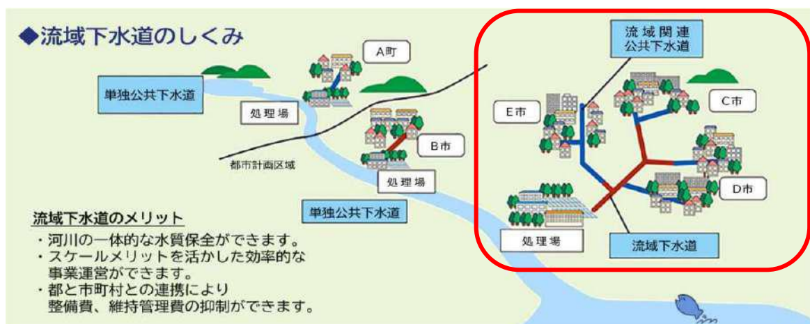
図 2-1 流域下水道のしくみ
